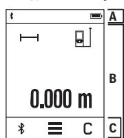
Дисплей делится на область статусной строки (A) и сенсорного дисплея (B) со строкой меню (C). На статусной строке отображается статус соединения Bluetooth®, температурное предупреждение и состояние заряженности аккумуляторных батарей/батареек. Измерительным инструментом можно управлять путем нажатия кнопок на сенсорном дисплее.
