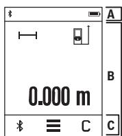
Дисплеят е разделен на областите лента на състоянието (A) и сензорен еcran (B) с лента с менюта (C). Лентата на състоянието показва състоянието на Bluetooth®, предупреждение за прегряване и състоянието на батерията. С помощта на сензорния еcran измервателният уред може да бъде управляван чрез докосване на екранни бутони.
