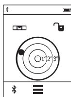
A digitális vízmérték egy tárgy (például mosogép, hűtőszekrény stb.) két tengely mentén egyidejűleg történő vízszintes irányú beállítására szolgál.
