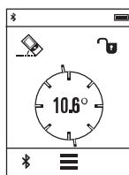
Режим измерения наклона служит для измерения подъема или уклона (напр., лестничных пролетов, лестничных площадок, при подгонке мебели, при прокладке труб и т. д.). В качестве плоскости отсчета выступает левая сторона измерительного инструмента. Если на дисплее не отображается угол наклона, это означает, что во время измерения измерительный инструмент слишком был сильно наклонен вбок. Текущее измеренное значение можно зафиксировать на дисплее, нажав кнопку измерения **1** или кнопку **2**.
