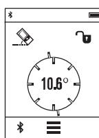
Мерењето на косини служи за мерење на нагорници и надолини (на пр. на скали, геленди, при вклопување на мебел, при положување на цевки итн.).
