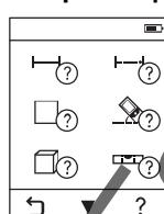
У вимірювальному інструменті для кожного режиму вимірювання є допомога у вигляді анімації. Спочатку натисніть на кнопку **k**, а потім на бажаний режим вимірювання. Анімація демонструє докладний порядок дій для обраного режиму вимірювання. Анімацію можна в будь-яку мить зупинити і розпочати знову. Її можна прокручувати вперед і назад.
