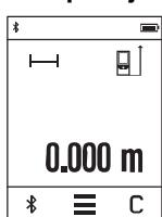
Nakon uključivanja mjerni alat se nalazi u funkciji mjerena dužina. Druge funkcije mjerena možete podestiti pritiskom na tipku **k** (vidi »Funkcije mjerena«, stranica 242).
