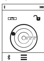
Дигиталната васер-вага служи запроверка на хоризонталното израмнување истовремено на две оски на еден објект (на пр. машина за пење, фрижидер итн.).
