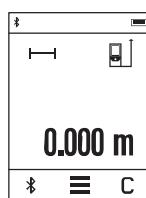
A mérőműszer a bekapcsolás után a hosszmérési funkcióban van. Más mérési funkciók beállításához meg kell nyomni a **k** gombot (lásd „Mérési funkciók”, a 70. oldalon).
