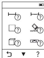
В измерительном инструменте для каждого режима измерения имеется помощь в виде анимации. Сначала нажмите кнопку **k**, а затем желаемый режим измерения. Анимация показывает подробный способ действия для выбранного режима измерения. Анимацию можно в любой момент остановить и начать сначала. Можно также прокручивать ее вперед или назад.
