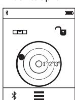
Digitalna tehnica se uporablja za preverjanje istočasne vodoravne poravnanoosti objekta na dve osi (npr. prašnega stroja, hladilnika itd.).
