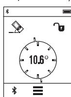
Nolieces mērišana ir izmantojama, lai izmērītu objektu stāvumu vai nolieci (piemēram, uzstādot kāpnes vai kāpņu margas, salāgojot mēbeles, ieguldot caurules u.c.).
