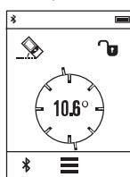
Funkcja pomiaru nachylenia służy do mierzenia wzgórz i nachyleń (np. schodów, poręczy, podczas dopasowywania mebli, przedłużania rur itp.).
