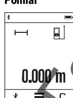
Po włączaniu urządzenie automatycznie ustawia się w funkcji pomiaru długości. Pozostałe funkcje pomiarowe można wybrać za pomocą przycisków **k** (zob. »Funkcje pomiaru«, str. 15). Po włączaniu automatycznie ustawiana jest tylna krawędź urządzenia pomiarowego jako płaszczyzna referencyjna (odniesienia). Zmiany płaszczyzny referencyjnej można dokonać za pomocą przycisków **e** (zob. »Wybór płaszczyzny odniesienia«, str. 14).
