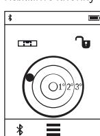
Цифровой ватерпас служит для проверки горизонтальности положения объекта по двум осям одновременно (напр., стиральной машины, холодильника и т. д.). Плоскостью отсчета для цифрового ватерпаса служит задняя часть измерительного инструмента. Текущее измеренное значение можно зафиксировать на дисплее, нажав кнопку измерения **1** или кнопку **2**.
