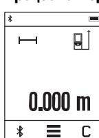
По вклучувањето, мерниот уред се наоѓа во функција на должинско мерење. Другите мерни функции може да ги поставите со притискање на копчето **C** (види „Мерни функции“, страна 188).
