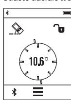
Meranie sklonu slúži na meranie stúpania alebo sklonu (napr. schodov, zábradlia, pri prispôsobení nábytku, pri pokladaní rúr atď.).
