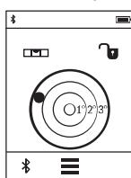
Цифровата либела служи за проверка на хоризонталното подравняване на обект едновременно спрямо две оси (напр. пералня, хладилник и др.п.).
