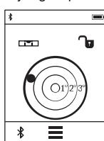
Digitaalne vesilood on ette nähtud eseme horisontaalseks nivelleerimiseks üheaegselt kahel teljel (nt pesumasin, külmkapp jm). Digitaalne vesilood lähtetasandiks on mõõteseadme tagakülg.
