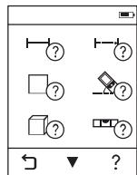
Измервателният уред има анимирана помощ за всеки режим на измерване. Първо изберете бутона **A**, а след това желания режим на измерване. Анимацията показва подробно стъпките за избраната функция.
