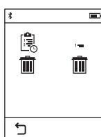
Po stisknutí tlačítka **h** můžete smazat celý seznam naměřených hodnot nebo jednotlivé naměřené hodnoty. Stisknutím tlačítka **h** se příslušná jednotlivá naměřená hodnota smaže.
