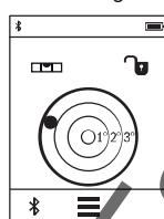
Digitalna libela služi za proveru horizontalnog poravnjavanja objekta (npr. mašina za pranje veša, frižider itd.) istovremeno u dve ose.
