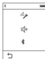
Če želite dostopati do menija „osnovne nastavitev“, pritisnite tipko **i** in nato tipko **o**. Zdaj pritisnite želeno tipko, tako da funkcijo izklopite oz. vklonite. Če je funkcija neaktivna, bo prikazana kot siv simbol, če pa je aktivna, bo simbol bel. Če želite zapustiti meni „osnovne nastavitev“, pritisnite tipko **n**.
