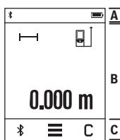
Екранот е поделен на полнијата статусна линија (A) и допирен еcran (B) со лента за мени (C). Статусната линија го покажува статусот на поврзување на *Bluetooth*<sup>®</sup>, предупредувањето за температура како и состојбата на наполнетост на батериите. Мерниот уред може да се контролира преку допирниот екран со допирање на копчињата.
